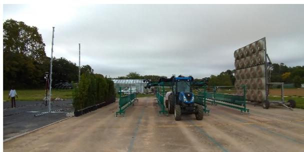
Figure 1: Dispositif de mesure de la dérive en conditions contrôlées (UMT EcoTech)
