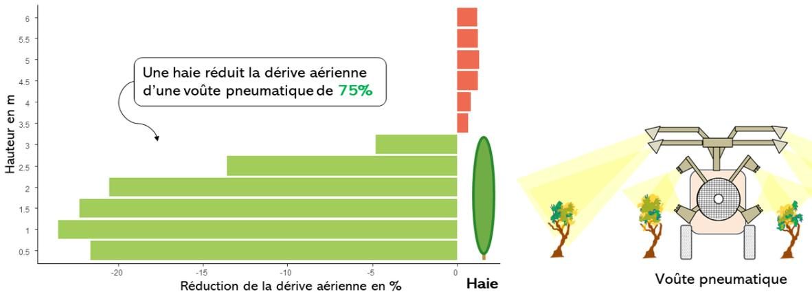
Figure 2: Réduction de la dérive aérienne d'une voûte pneumatique grâce à une haie
