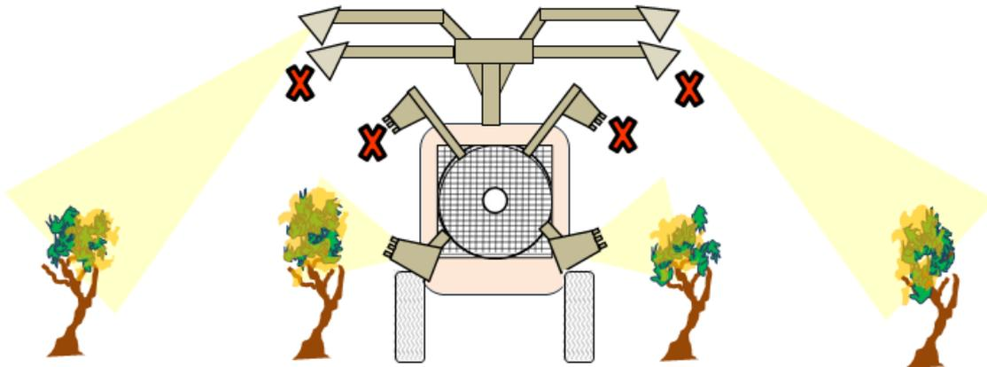
Figure 2: Fermer les diffuseurs inutiles !
