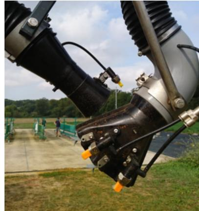
Figure 4: Voûte pneumatique équipée en jet porté
